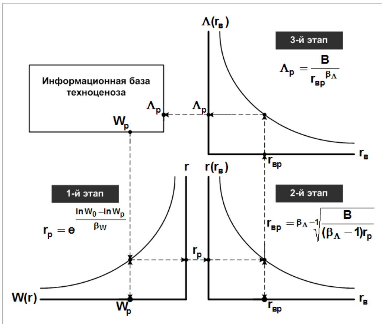
Рис. 3.4. К методике, реализующей техноценологический подход к параметрической оптимизации (индекс «Р» имеют расчетные значения соответствующих параметров техники)
