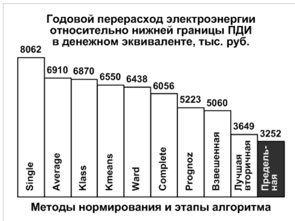
Рис. 4.57. Годовой перерасход электроэнергии исследуемого техноценоза относительно нижней границы ПДИ в денежном эквиваленте (в тыс. руб.)
