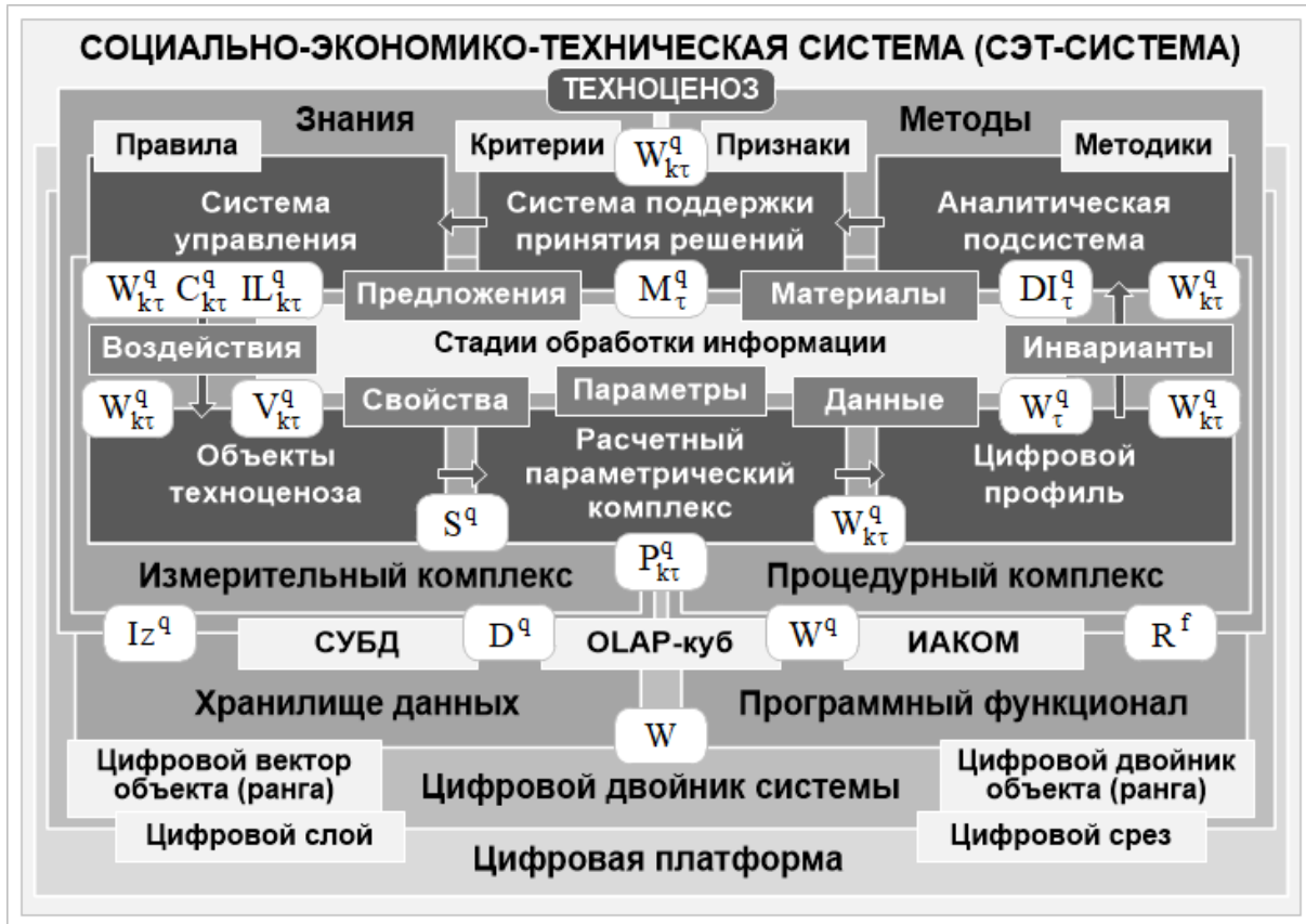
Рис. 12. Стадии обработки информации в процессе управления электропотреблением
