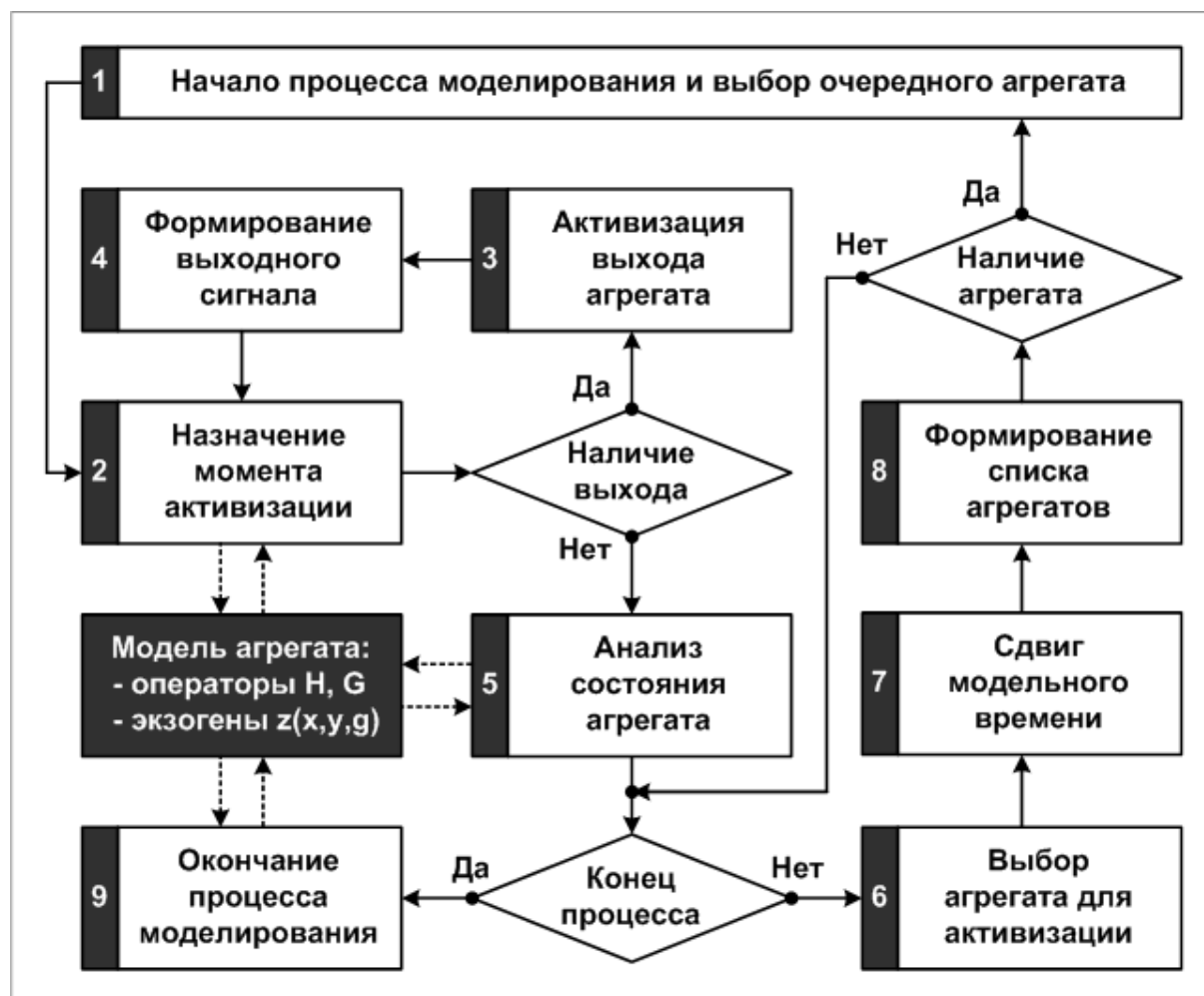
Рис. Схема алгоритма имитационного моделирования процесса функционирования агрегата
