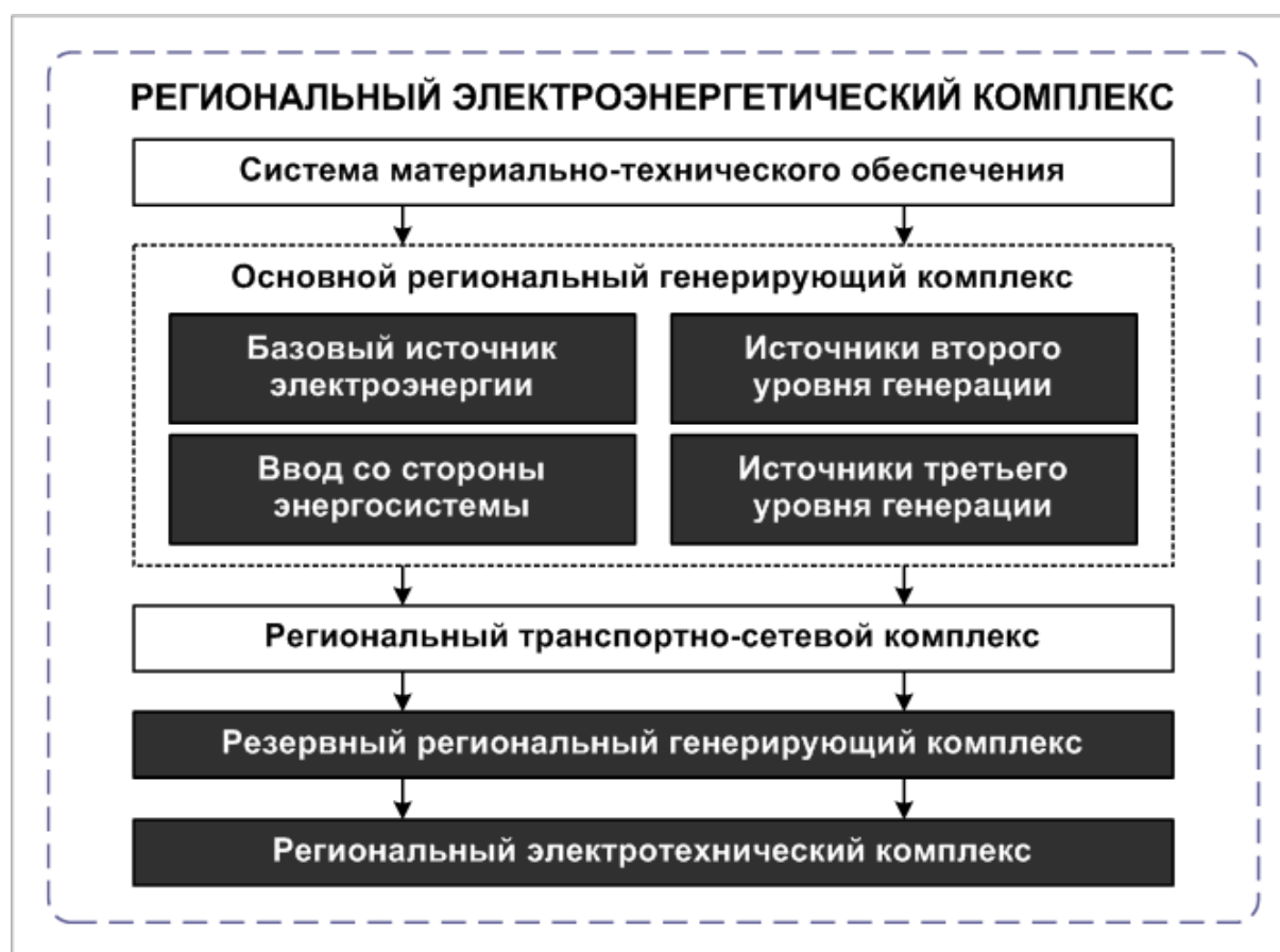
Рис. 1. Основной состав и структура регионального электроэнергетического комплекса
