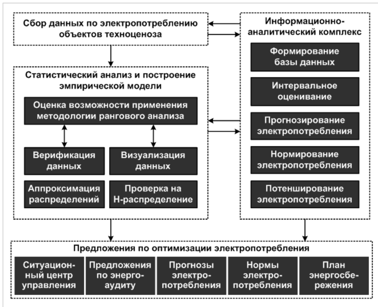
Рис. 6. Методика управления региональным электротехническим комплексом
